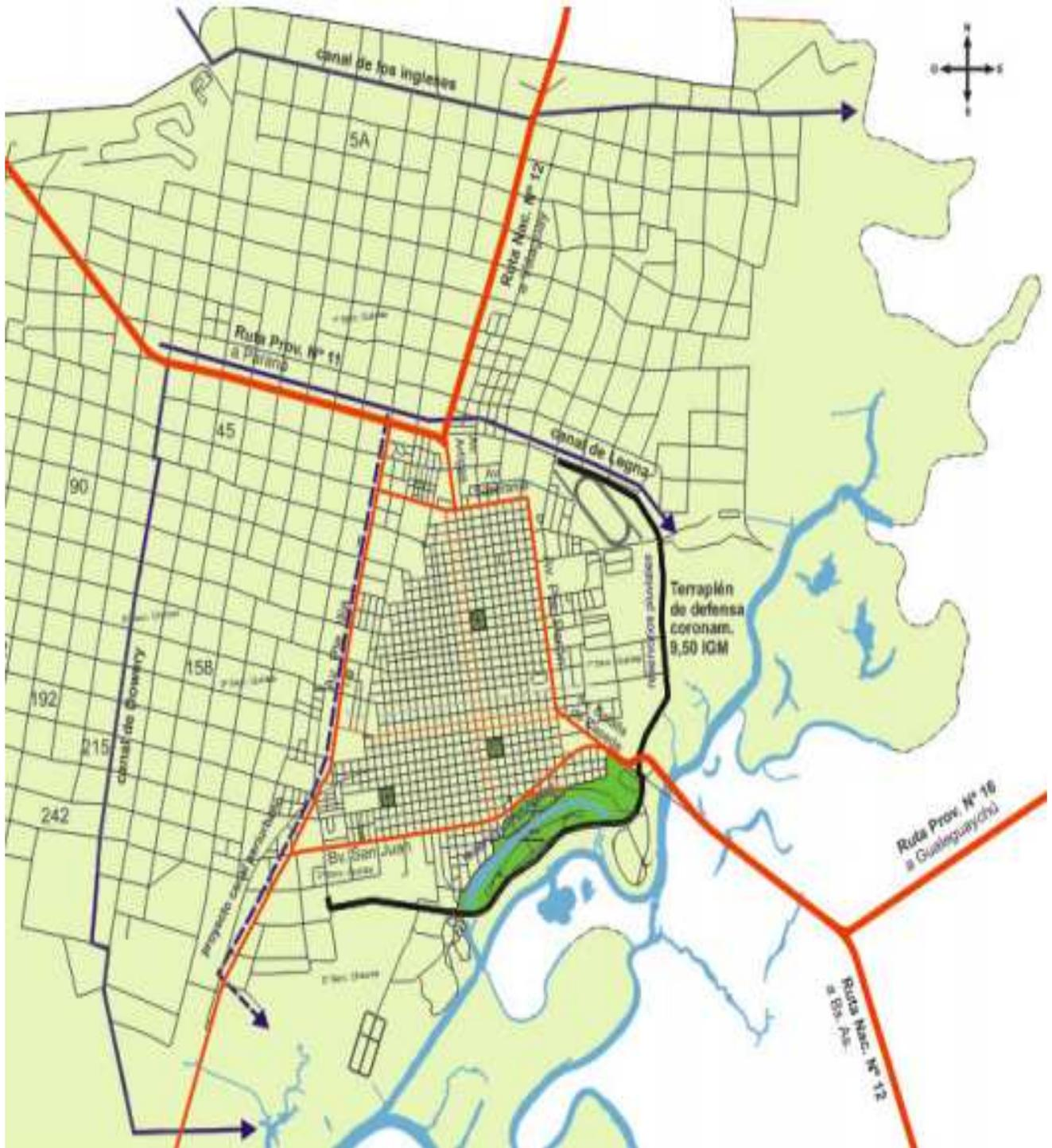
Figura nº 02-61: Canales interceptores del escurrimiento pluvial
