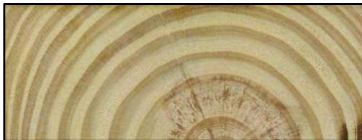
Figura 1. Anillos de crecimiento en una sección de madera de pino resinoso
