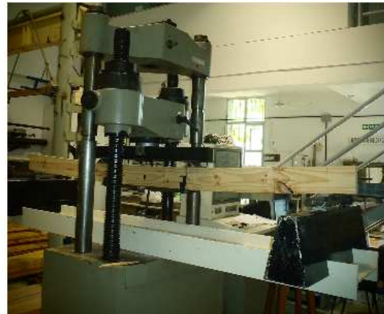
Figura 3. Disposición para el ensayo a flexión estática.
