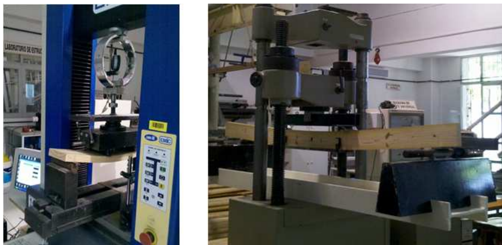
Figura 2. Ensayo estático de flexión. Izq.: Flexión de plano. Der.: Flexión de canto
