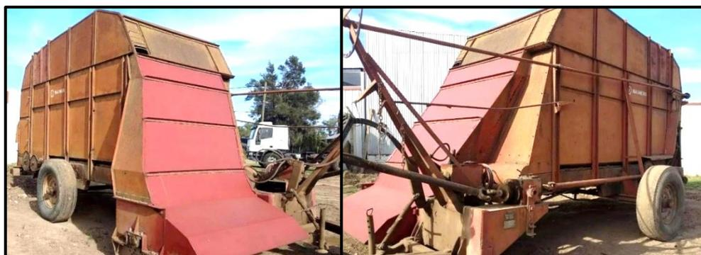
*Figura 1 - Perspectivas de la picadora integral de forrajes Mainero. Modelo: UF150X. Año de fabricación: 1980. Potencia requerida: 65 HP. Ancho de corte: 1,5 m. Capacidad de almacenaje: 12 m<sup>3</sup>. Con descarga lateral (Concesionaria El Chaparral, s.f.).*
