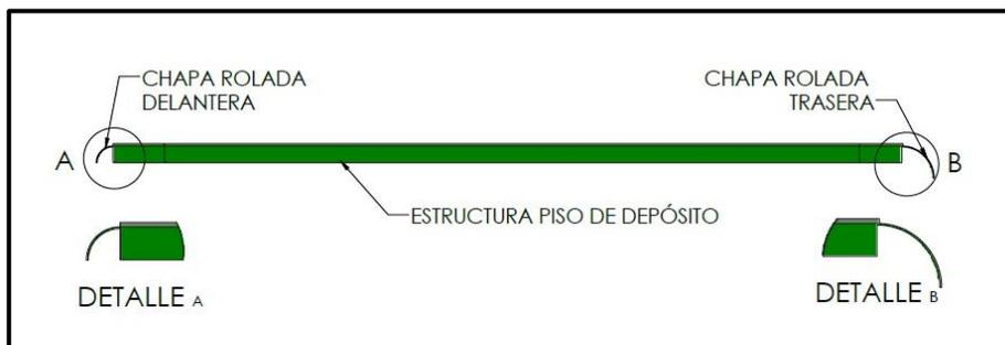
Figura 107 - Chapas roladas en los extremos del piso del depósito.
