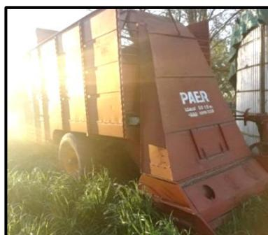
*Figura 2 - Picadora integral Paer. Modelo: Ideal. Año de fabricación: anterior a 1990. Ancho de corte: 1,5 m. [Fotografía de Cristian Malasisi] (Inrville. 2018).*
