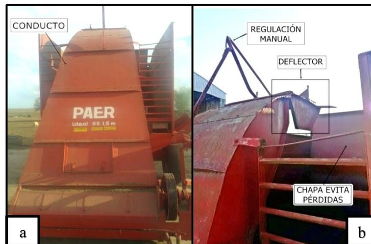
Figura 5 - Diseño utilizado para conducir el forraje hacia el depósito en picadora Paer (similar al utilizado por Mainero).
