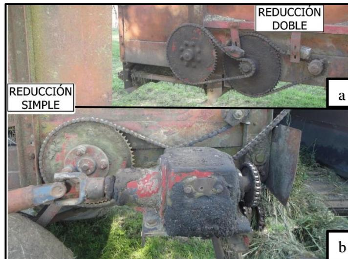
Figura 7 - Sistema de reducción de velocidad del primer subsistema de descarga en la picadora Mainero.
