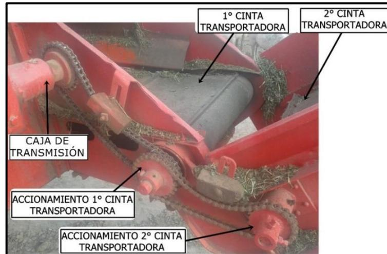
Figura 9 - Tercer subsistema de descarga en la picadora Paer. Desde la caja de transmisión, se acciona la primera cinta y desde allí la segunda.
