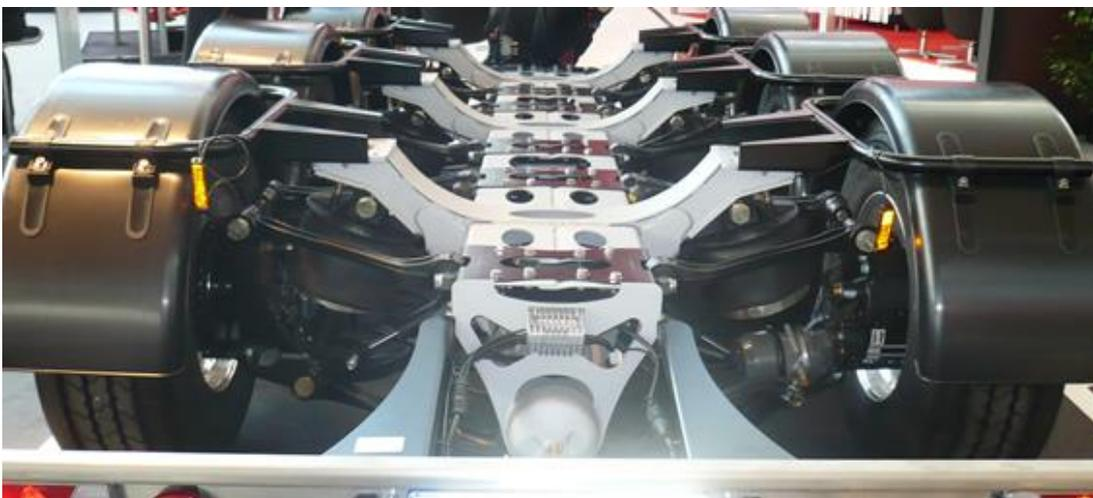
*Figura N° 40. Esquema de suspensión independiente de prototipo presentado en el exterior.*
