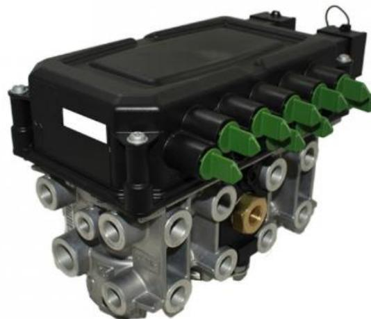
Figura N° 96. Módulo EBS configuración 4S/2M.
