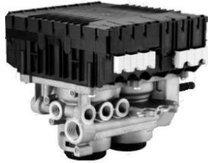
Figura N° 91. Conjunto que contiene la ECU y Válvulas del ABS.
