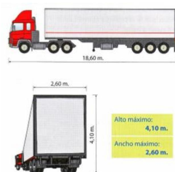
Figura N° 3. Ilustración de las máximas dimensiones permitidas.
