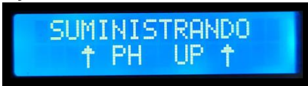
Figura N° 40: Pantalla mientras suministra Hipoclorito de Sodio.
