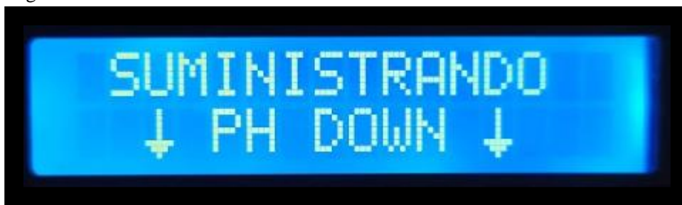
Figura N° 46: Pantalla mientras se da el suministro de Ácido Clorhídrico.
