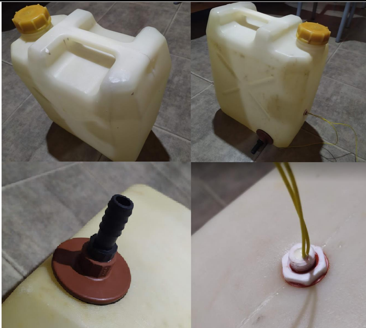
Figura N° 82: Modificaciones en bidón de Hipoclorito de Sodio.
