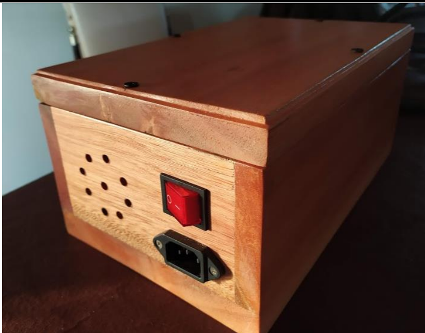
Figura N° 84: Caja de madera: Salida de aire, Ficha hembra 220v, Tecla de encendido de fuente.
