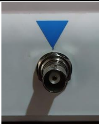
Figura N° 89: Caja estanca instrumento: Ficha BNC para el electrodo de pH.
