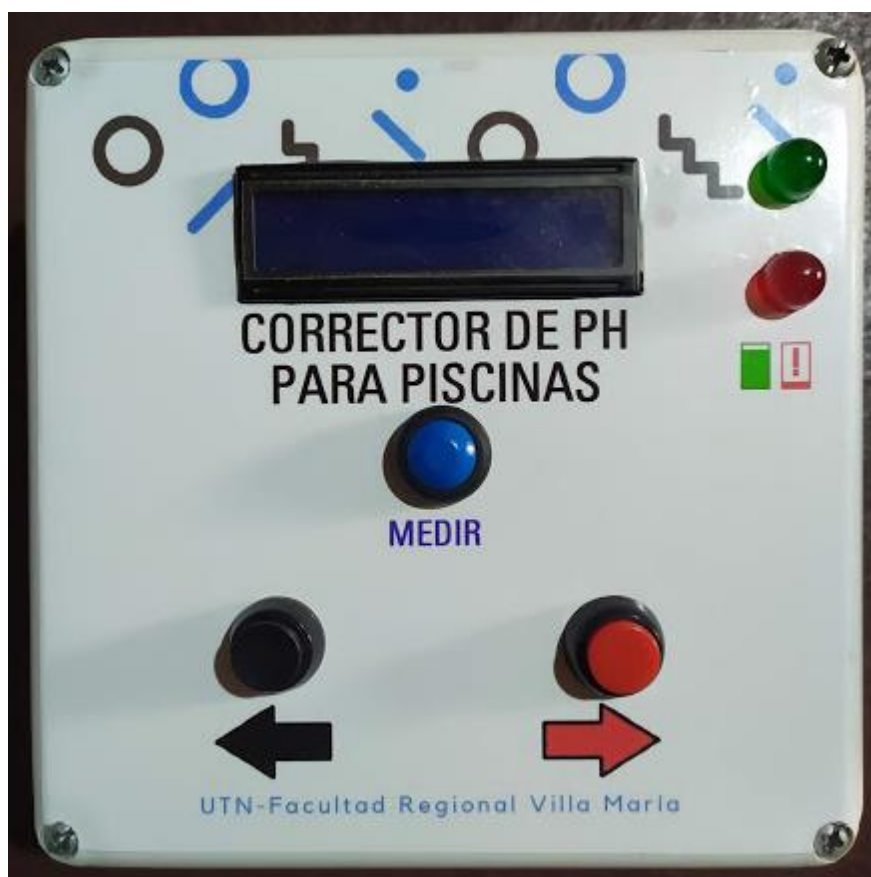
Figura N° 90: Caja estanca instrumento: Botonera, LCD 16x2, Leds de notificación.
