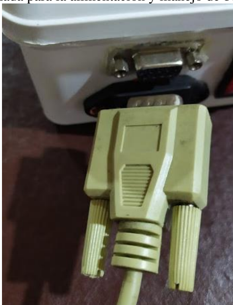
Figura N° 28: Cable y ficha DB9.
