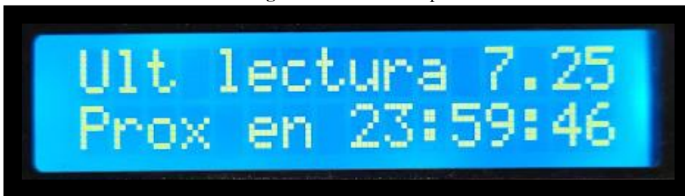
Figura N° 65: Mensaje en espera de 24 horas luego de medida apta.
