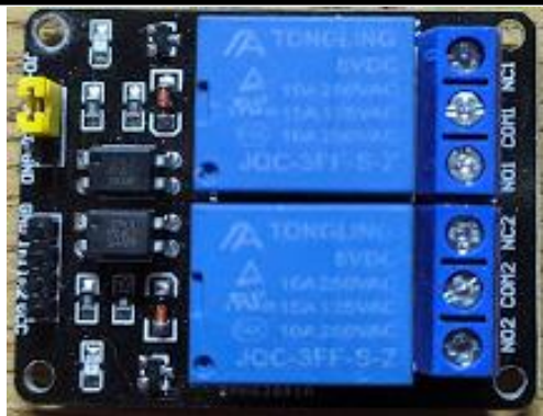
Figura N° 18: Módulo de relés.
