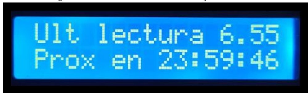
Figura N° 63: Pantalla de espera de 24 horas para volver a comenzar.
