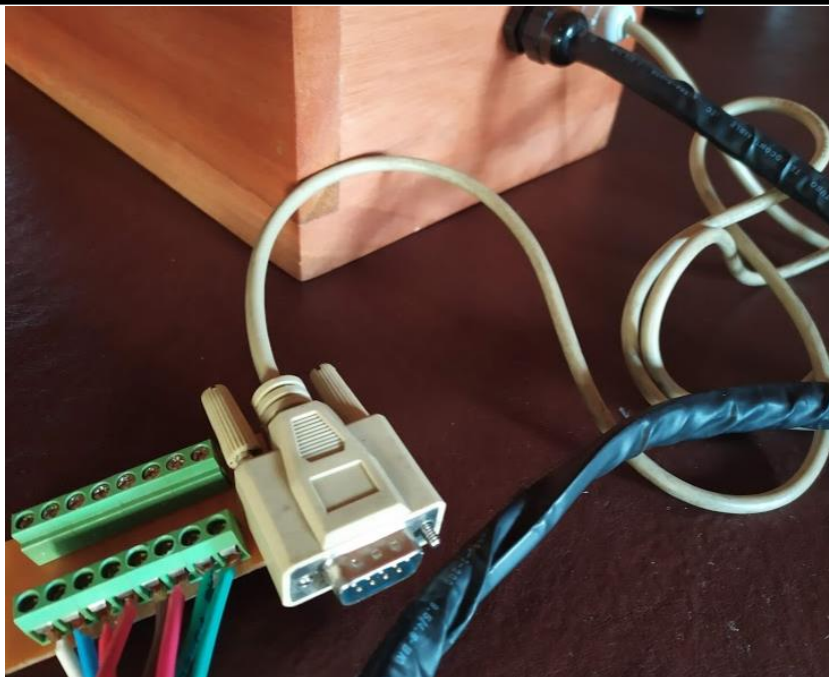
Figura N° 86: Caja de madera: Ficha DB9 para el instrumento, y placa con borneras para alimentación las bombas y sensores.
