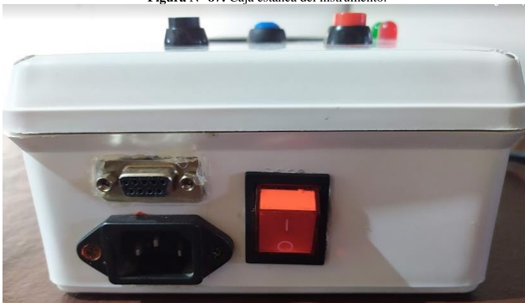
Figura N° 88: Caja estanca instrumento: Hembra DB9, Hembra 220v, Botón de encendido.
