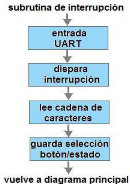
Figura N°31.- Diagrama de flujo de subrutina de interrupción disparado por UART.
