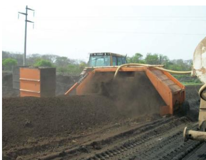
Volteo de pilas
