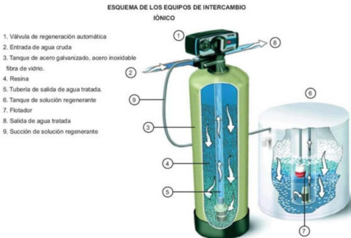
Figura 8 – Esquema de los equipos de tratamiento de agua de intercambio iónico
