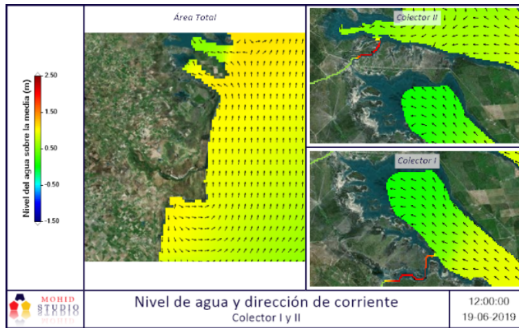
Figura 80: Nivel de agua y dirección de corriente-Colector I y II
