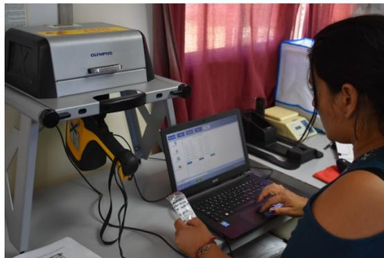
**Fig. 3.** Espectrómetro portátil Olympus Delta DP-6000 GeoChem Analyzer para análisis de XRF de la Universidad de Nevada utilizado en el Laboratorio de Arqueología en el CTDR – FRSR – UTN
