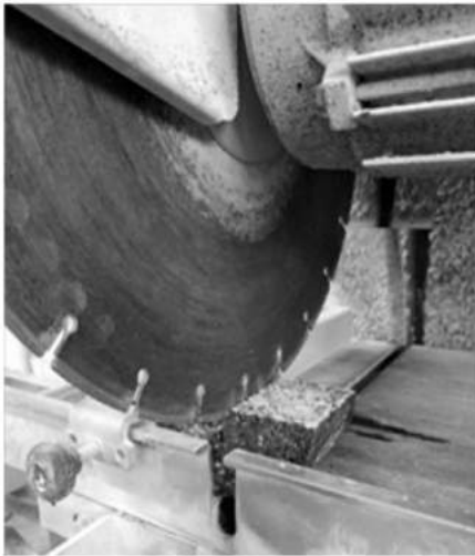
Figura 6. Entalladura de la probeta semicilíndrica
