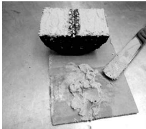
Figura 12. Preparación de resina epoxy
