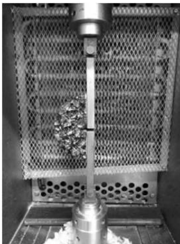
Figura 15. Colocación de probeta para el ensayo
