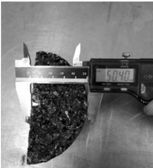
Figura 8. Medición de D_t
