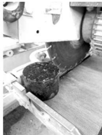
Figura 5. Corte de la probeta por la mitad
