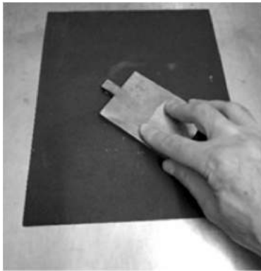
Figura 10. Lijado superficie de apoyo de soporte
