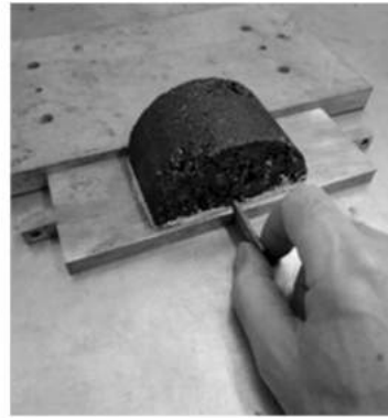
Figura 14. Extracción de la pletina
