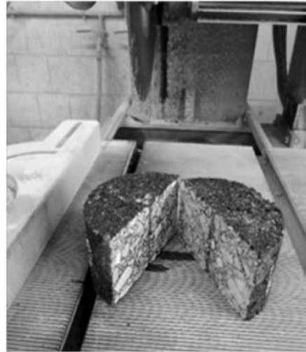
Figura 7. Probetas preparadas para ensayo
