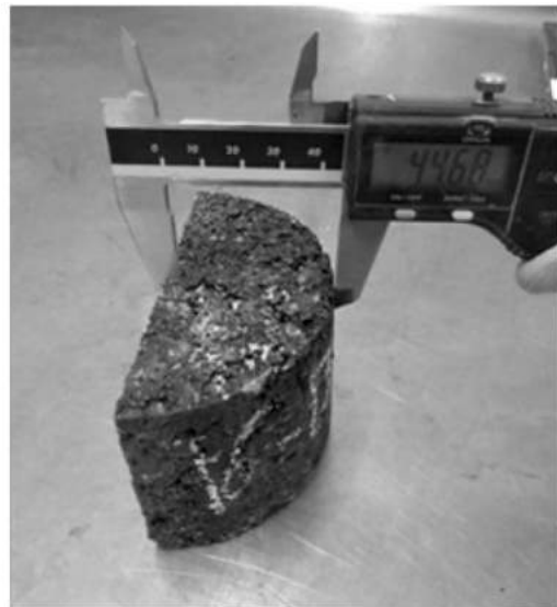
Figura 9. Medición de D_r
