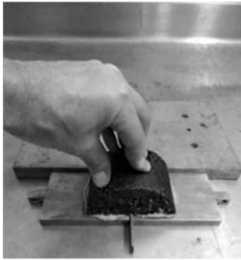
Figura 13. Pegado de probeta sobre soporte
