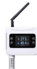
Imagen 10, a modo ilustrativo controlador con sensor de condiciones ambiente
