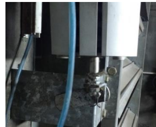
Figura 16, vinculacion de un servo al mecanismo de una persiana
