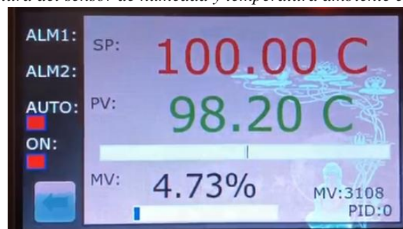
Figura 51. Vista en pantalla de parámetros de entrada y salida de un controlador PID (Set Point, Process Value y respuesta)
