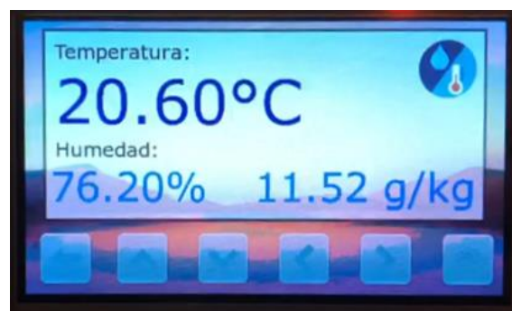
Figura 50. Lectura del sensor de humedad y temperatura ambiente en el controlador.
