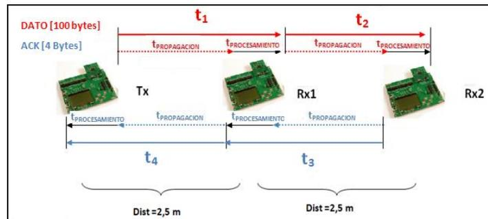
Fig. 7. Topología del ensayo con un nodo intermedio.
