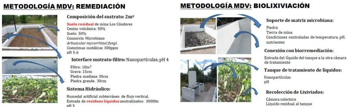
**Fig. 6.** Esquemas de llenado de piletas para los ensayos de remediación y biolixiviación en el escalamiento del proyecto BioCriticalMetals.
