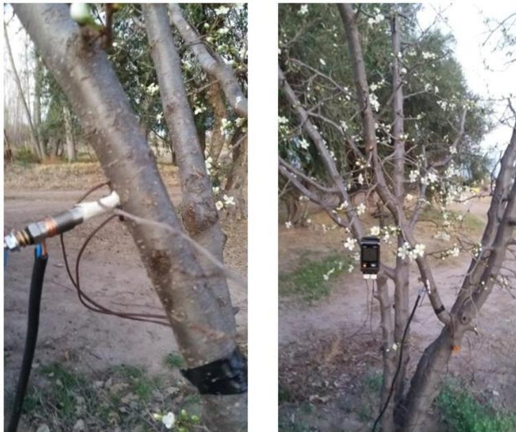
**Fig. 1.** Ensayo de Pulso de calor, donde se muestran los elementos utilizados, a la izquierda la bujía de calentamiento y las sondas y a la derecha datalogger
