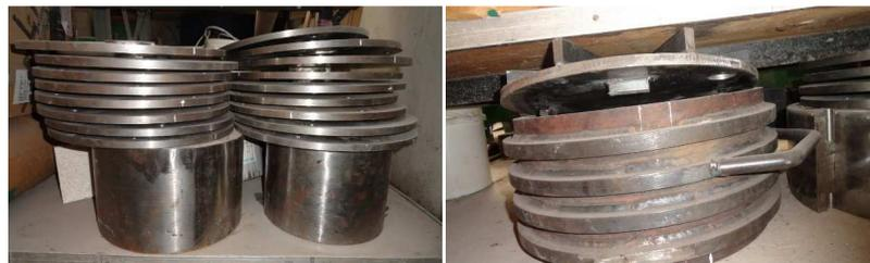
**Fig. 3.** Fotografías de los moldes internos y externos junto a pletinas de conexión y discos de rigidización
