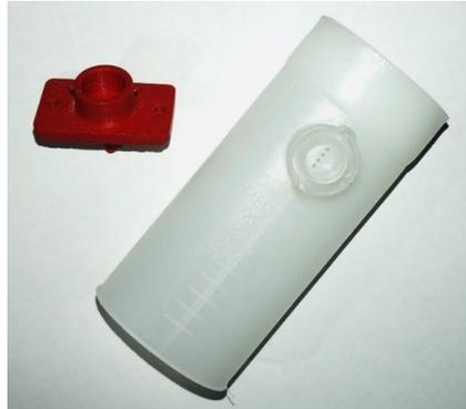
**Fig. 4.** Sensor de flujo y conector diseñado para acoplar la salida de presión diferencial.
