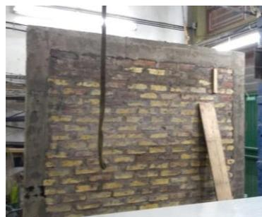
**Fig. 5.** Muro de mampostería encadenada simple construido.
