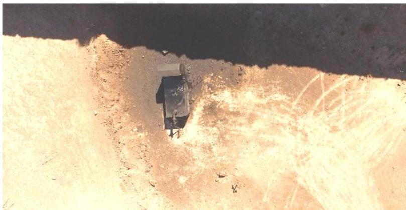
Fig. 4. Deposición de Hidrocarburo que sale de un escape gaseoso.
