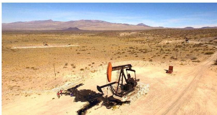
Fig. 3. Derrame de crudo en el Yacimiento, en el punto de bombeo.
