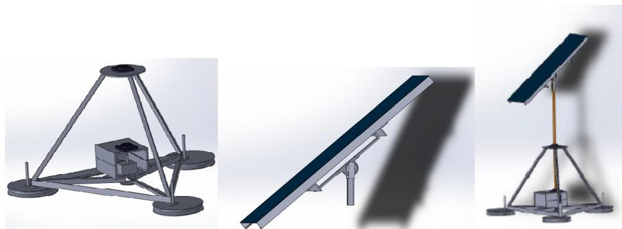
Fig. 4. Partes del diseño con software CAD del panel móvil
