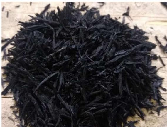
**Fig. 1.** Fibras de caucho reciclado, tras trituración secundaria.
