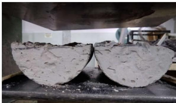
**Fig. 3.** Ensayo de tracción por compresión diametral.
