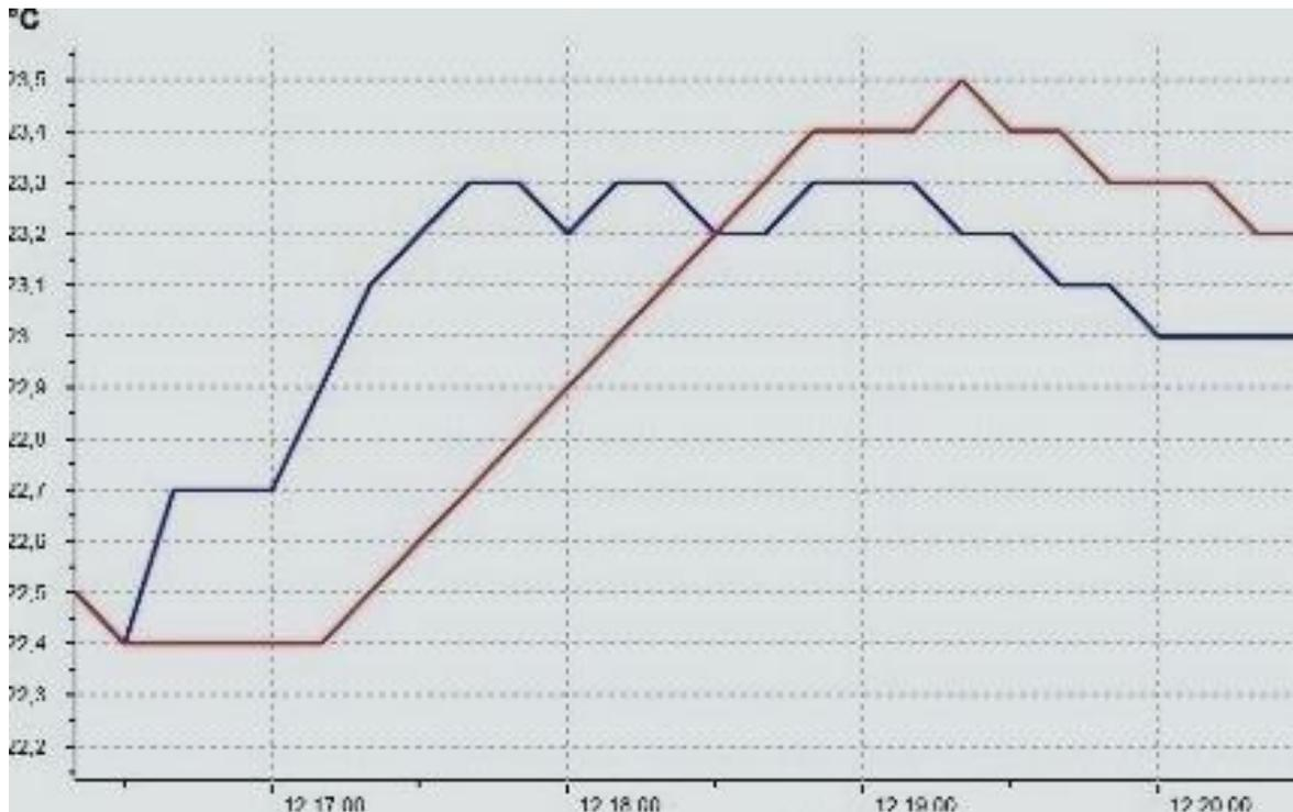
**Fig. 2.** Datos obtenidos con el datalogger. Curva azul temperatura sensor inferior y curva roja temperatura sensor superior.
