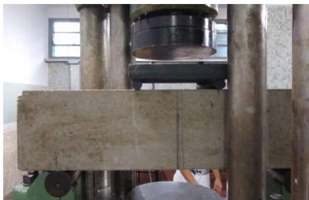
**Fig. 4.** Ensayo de tracción por flexión.
