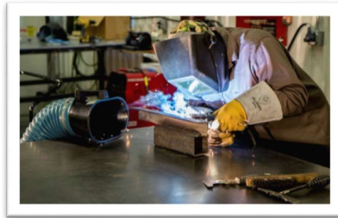
31 Trabajador soldando con sistema extractor de humos
