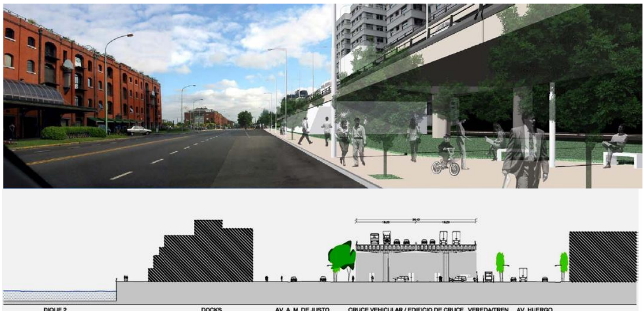
Figura 3-7: Corredor Ribereño en viaducto elevado
