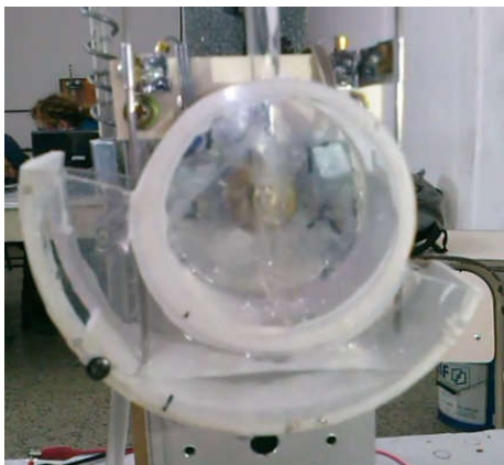
Posición de reposo del sistema de captura. En donde comienza a acumularse la precipitación capturada.
