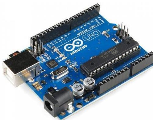
Figure 30. Arduino UNO V3.<sup>59</sup>
