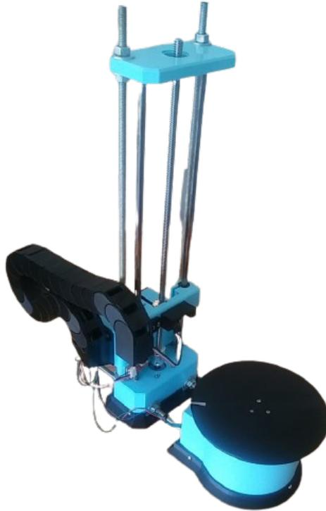
Figure 13. Imagen del escáner láser 3D ensamblado.
