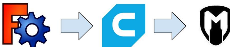
Figure 4. Flujo de trabajo. primero FreeCAD, luego Cura y finalmente la Impresora 3D.
