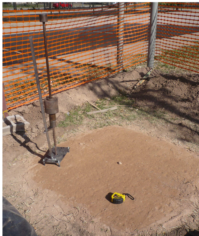
Figura 3.31 Ensayo DCP (celda 2)
