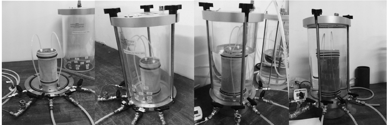
Figura 3.12 Secuencia de montaje de muestra en ensayo a pared flexible
