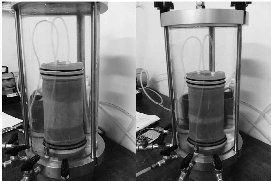
Figura 3.16 Secuencia de saturación de una muestra
