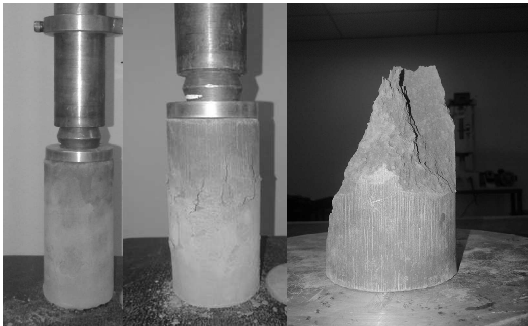
Figura 3.28 Secuencia de montaje, instante de falla y rotura
