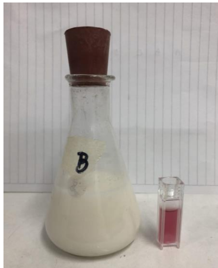
Figura 15 - Muestra y cubeta preparada para espectrofotometría
