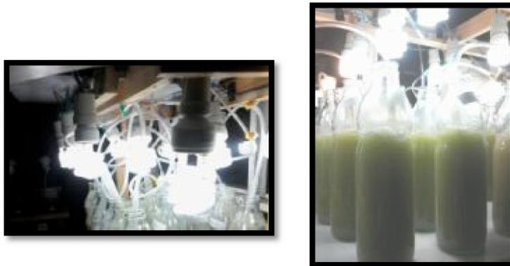
**Figura 13. Imágenes del arreglo de fotorreactores utilizados en el experimento de co-cultivo de *Scenedesmus dimorphus* y *Azospirillum brasilense***
