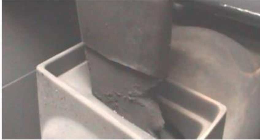
Figura 52. Sin protección de interruptor de puesta a tierra ultra rápido. Fuente: ABB
