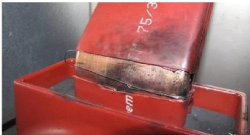
Figura 53. Con protección de interruptor de puesta a tierra ultra rápido. Fuente: ABB
