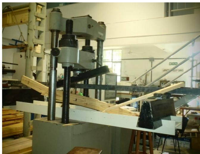
Figura N° 24: Rotura en ensayo a flexión de un cuerpo de prueba.
