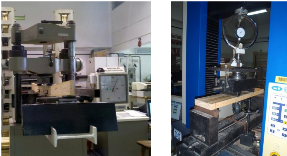
Figura N° 20: Ensayo a flexión estática. (Izquierda) Máquina de ensayo universal Shimadzu. (Derecha) Máquina de ensayo universal EMIC.
