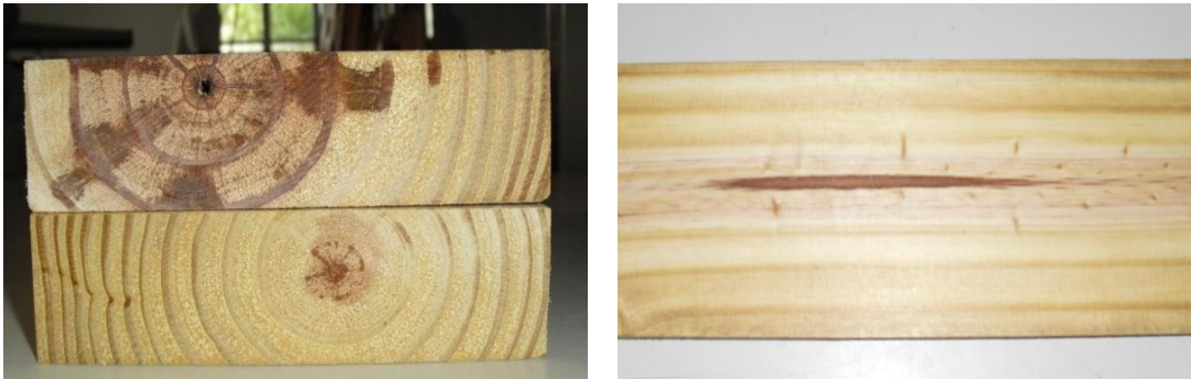
Figura N° 11: Médula. (Izquierda) En el interior de la pieza. (Derecha) En la superficie de la pieza.
