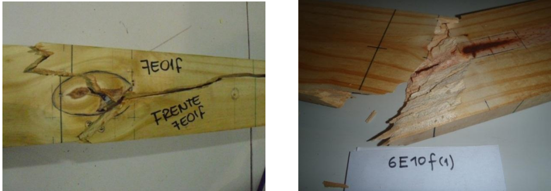
Figura N° 25: Rotura de un cuerpo de prueba con anomalías: (Izquierda) presencia de nudo. (Derecha) existencia de médula.
