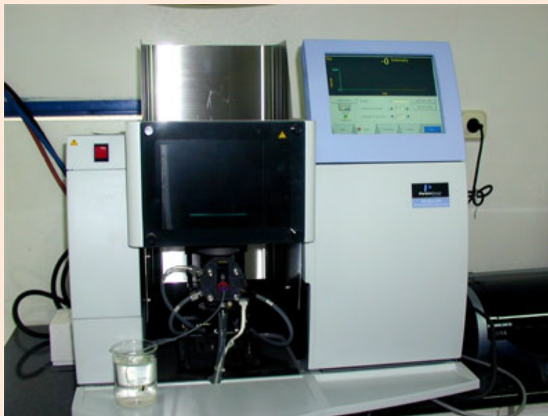
Fig. 2. Espectrofotómetro de Absorción Atómica marca Perkin Elmer modelo Analyst 200.
