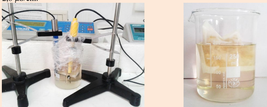
Fig. 4. Izquierda: sistema de medición de pH y conductividad de la disolución de zampa. Derecha: semillas contenidas en sobre poroso en contacto con agua destilada.
