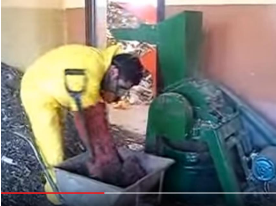
Foto 10: Segunda Molienda o Molienda Fina del RO Inertizado. Fuente: Cooperativa Valle del Conlara.
