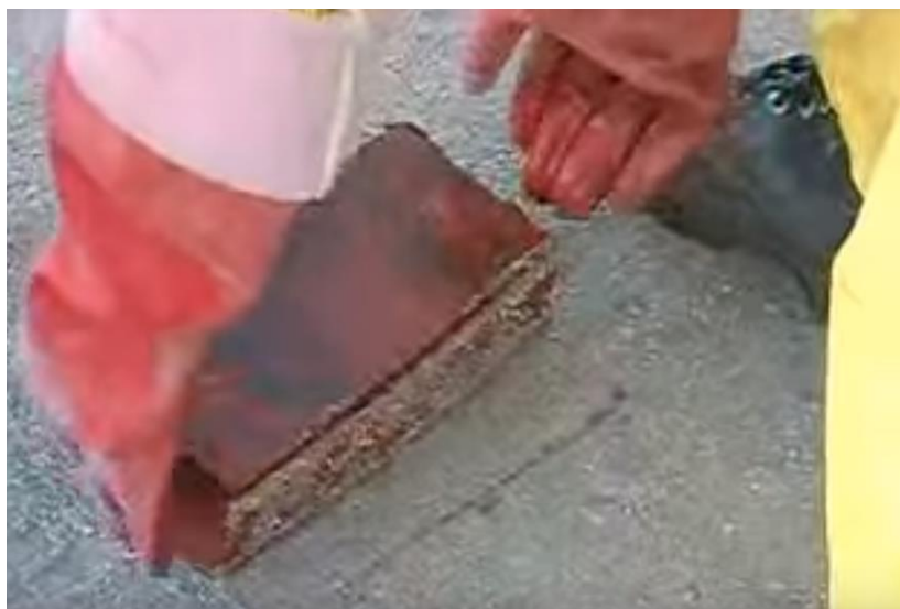
Foto 21: Una vez moldeado el ladrillo se pasa por arena. Fuente: Cooperativa Valle del Conlara.
