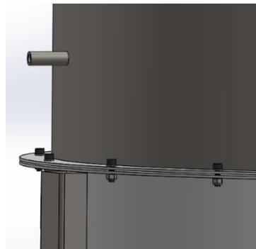
Fig. 43. Diseño ducto sensor de temperatura
