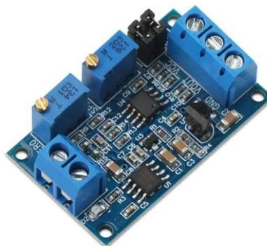
Fig. 53. Conversor de Señales Electrónico
