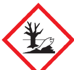
DAÑO AL MEDIO AMBIENTE
