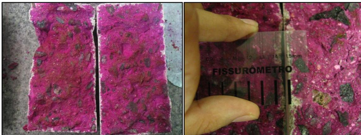
Figura 6.22 Medición de profundidad de carbonatación en probetas
