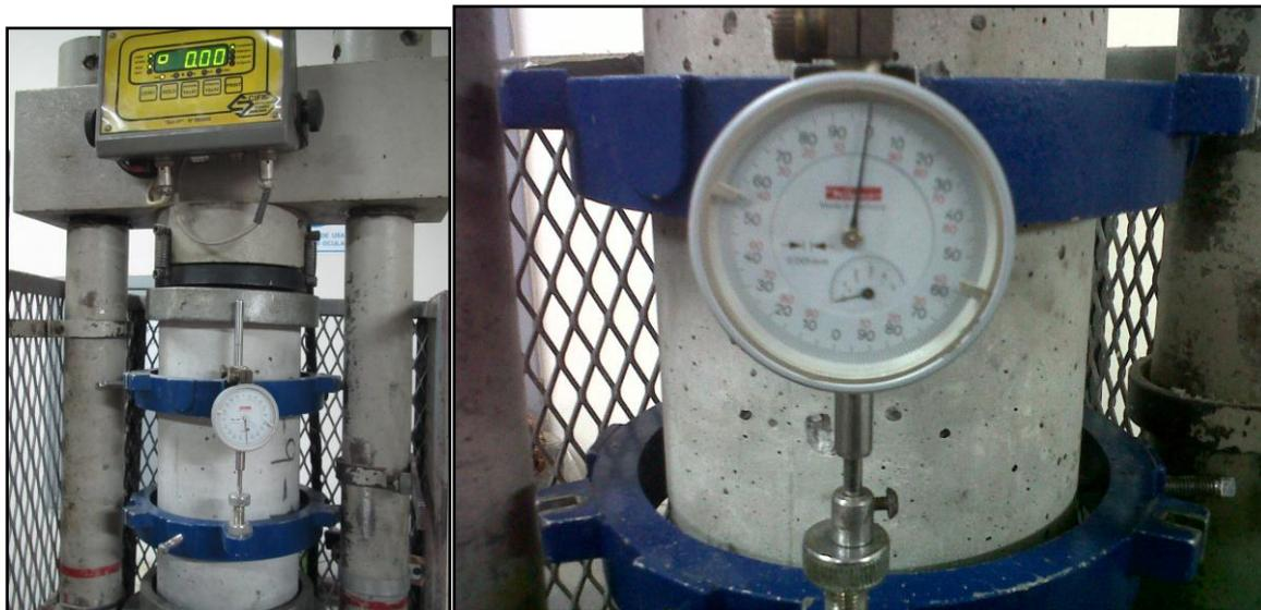
Figura 5.6 Determinación del módulo elástico
