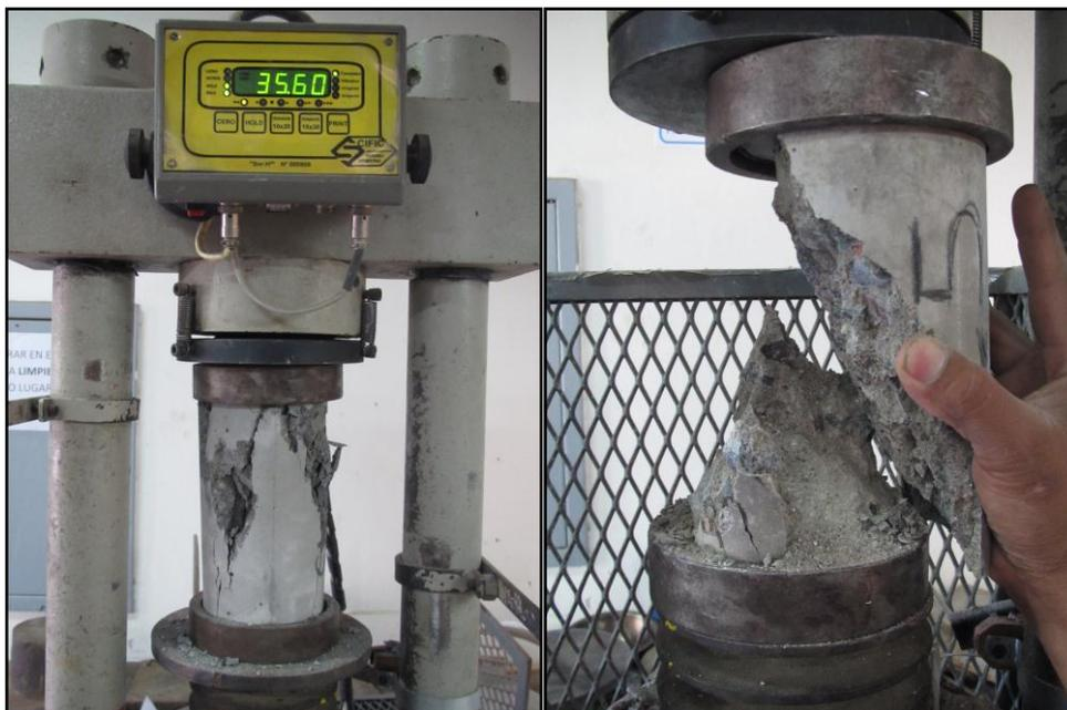
Figura 5.4 Probeta ensayada a compresión axial
