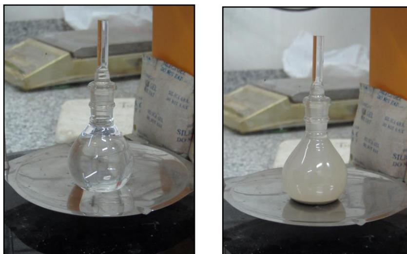
Figura 6.1 Picnómetro con agua destilada a la izquierda y con agua y la muestra a la derecha
