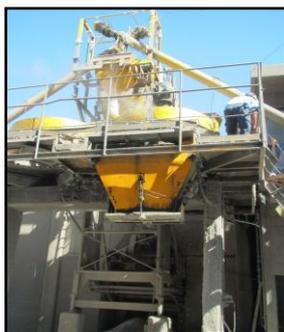
Figura 9.1 Proceso de fabricación: mezcladora y tolva de descarga.
