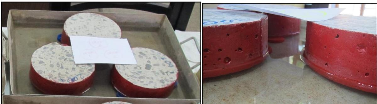
Figura 5.7 Probetas durante la determinación de la capacidad de succión capilar.
