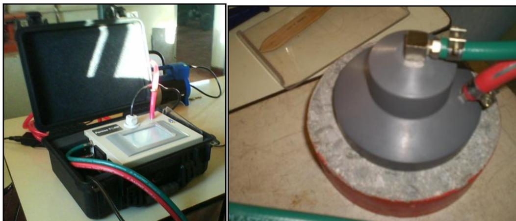
Figura 5.9 Medición de la permeabilidad al aire con equipo PermeaTORR™
