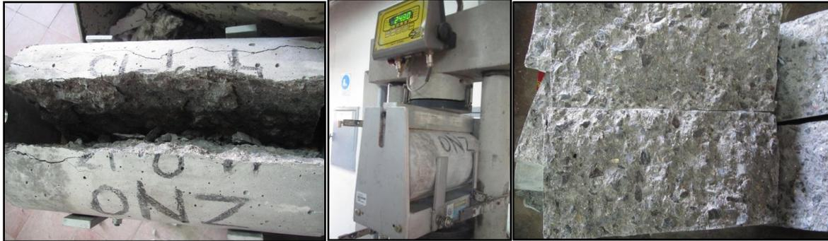
Figura 5.5 Probeta ensayada a tracción por compresión diametral.
