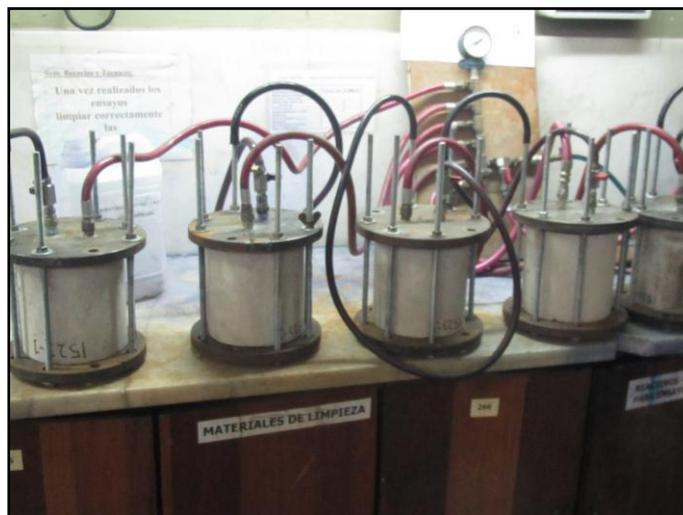
Figura 5.10 Resistencia a penetración de agua a presión
