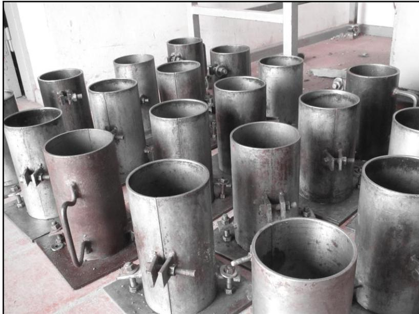
Figura 5.3 Moldes para probetas
