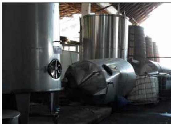
Figura 3 Daño en depósitos de vino. Terremoto de Chile en 2010 [8].
