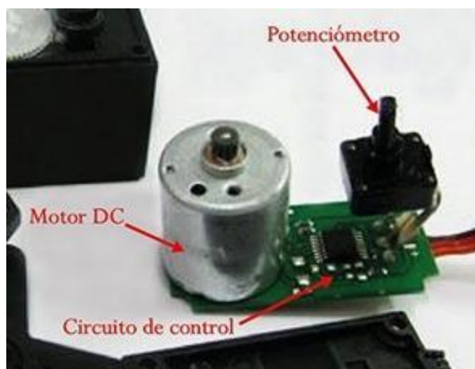
Figura 4. Componentes básicos de un servomotor.
