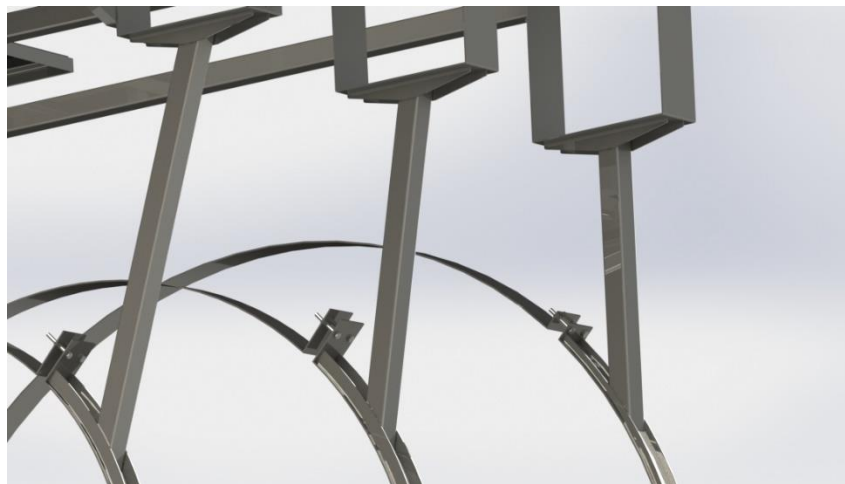
Figura 63: cartelas refuerzos parte de abajo zuncho lado pontón y lateral zuncho lado difusor.
