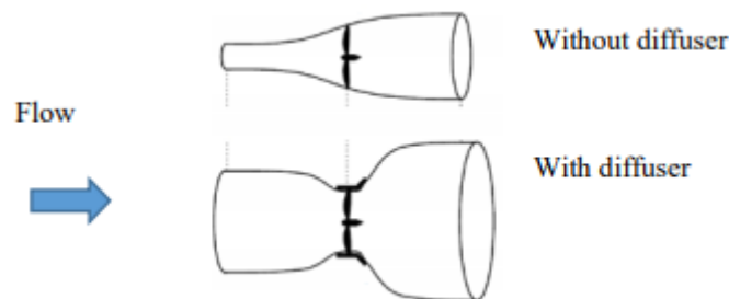
Figura 8: comparación de secciones de paso para turbinas con y sin difusor
