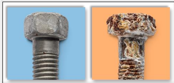
Figura IV.3 - Corrosión en cincado (izq.) - Corrosión en acero al carbono (der.)
