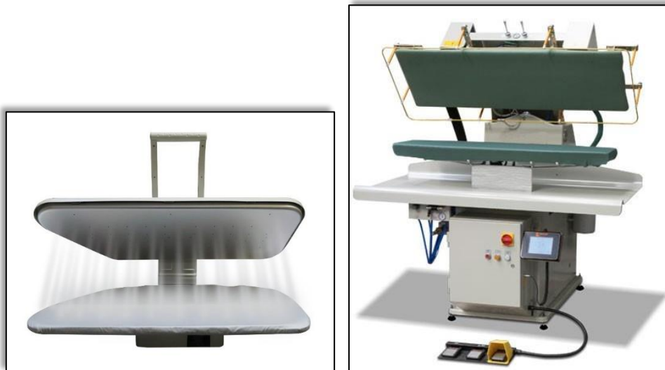
Figura II.5 - Plancha prensa doméstica (izq.)- Plancha prensa industrial (der.)
