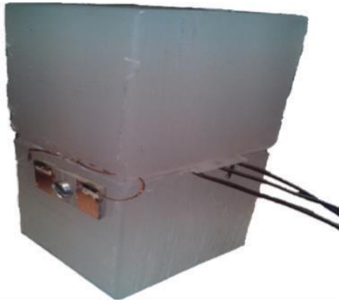
Fig. 31. Ensayo de medición perfil de temperaturas de malla y polímero
