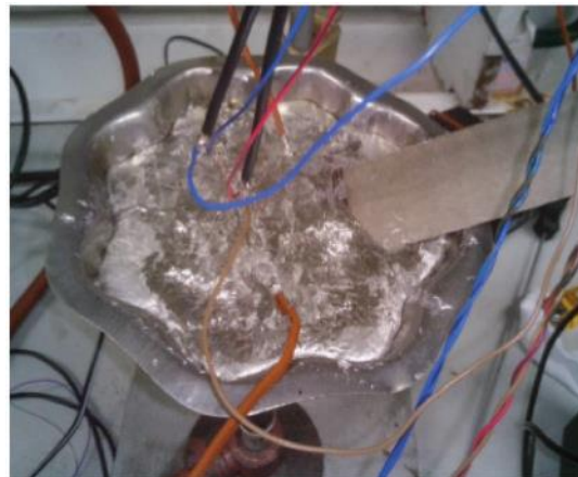
Fig. 34 y 35. Ensayo de verificación de resistividad del cobre
