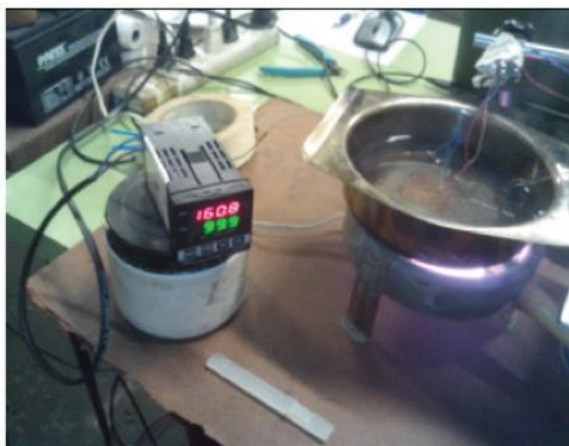
Fig. 34 y 35. Ensayo de verificación de resistividad del cobre
