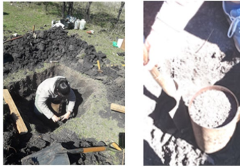
Calicata, excavación y tallado - Obtención Muestra Inalterada
