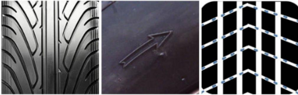
Figura 3.11: Dibujo direccional del rodado.
