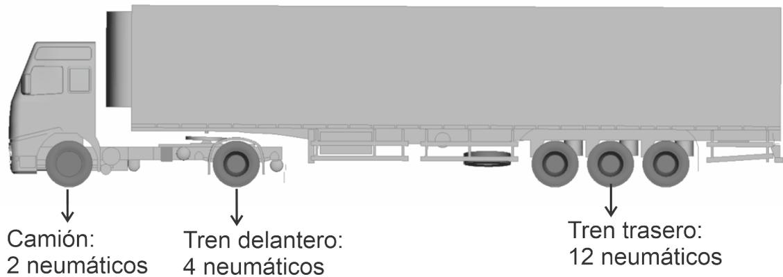
Figura 10.11: Distribución de los neumáticos en el semirremolque.
