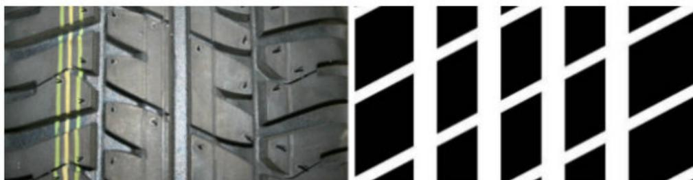
Figura 3.9: Dibujo simétrico del rodado.
