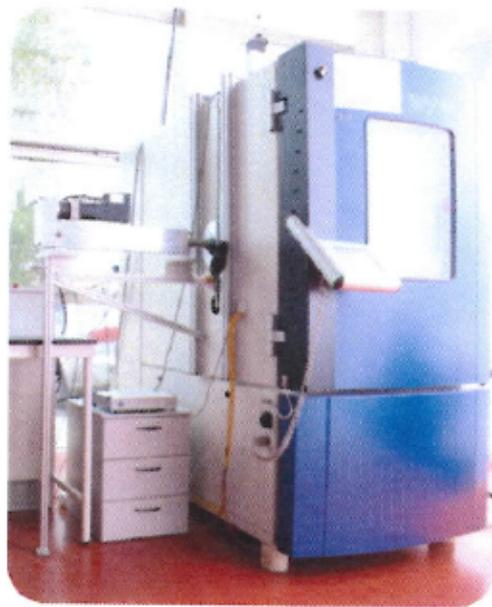
Figura 5.1: Maquina ensayos para la medición de coeficientes de fricción, tribo-tech 300.
