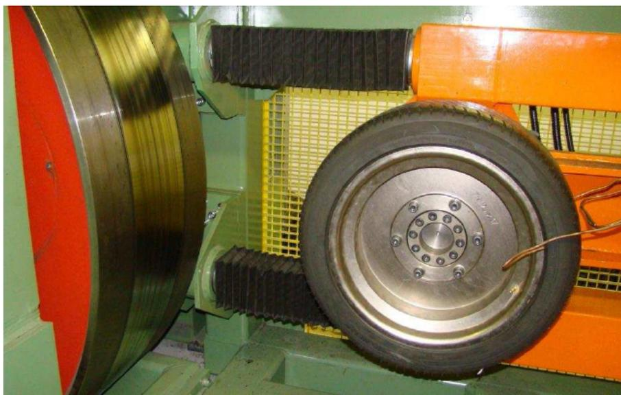
Figura 2.5: Neumático montado en la máquina de medición.
