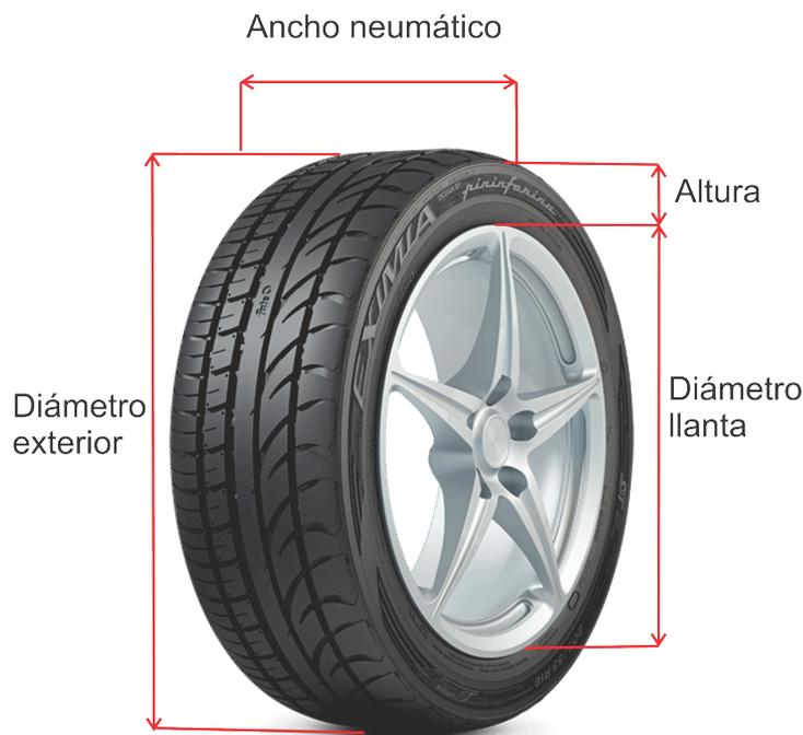
Figura 3.12: Parámetros del neumático y llanta .
