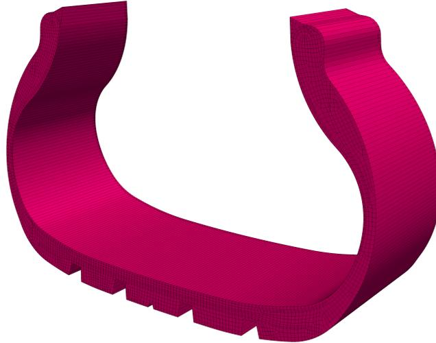
Figura 7.12: Irregularidades geométricas del perfil del neumático.
