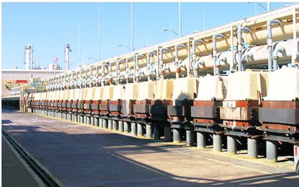
Imagen: Celdas de diafragma en la fabricación de cloro. Tomado de http://www.sapiensman.com/tecnoficio/electricidad/electrolisis_y_cloro.php
