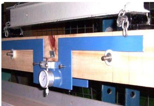
Figura 2. Dispositivo para medición de deformaciones
