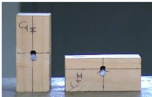
Figura 4. Probetas ensayadas con perno de 12 mm.
