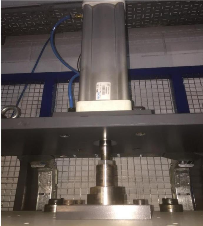
**Imagen 29: Cilindro Neumático Seleccionado, montado sobre el dispositivo.**
