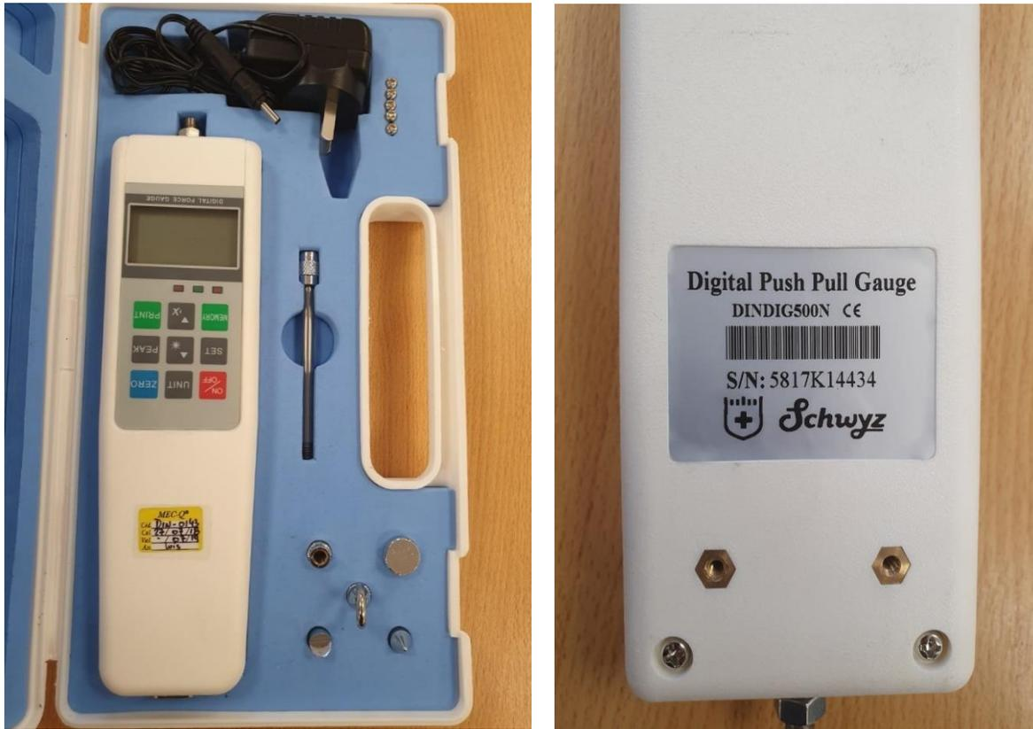
**Imagen 24: Dinamómetro utilizado para determinar la fuerza de clipsado**
