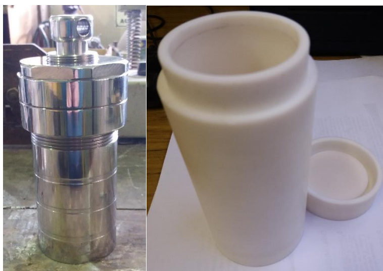
Figura 2.2: izquierda, autoclave o reactor hidrotérmico de 200 mL. Derecha, el vaso de teflón que se coloca en su interior.
