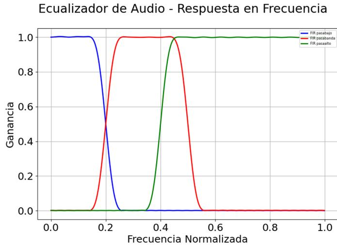
*Fig. 57 – Respuesta en frecuencia normalizada de los filtros pasa bajos, pasa banda y pasa altos del ecualizador*
