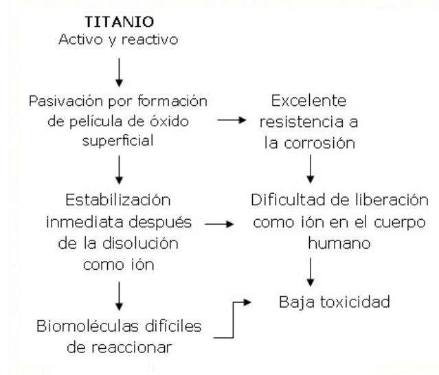
Figura 32 Condiciones de baja toxicidad de la capa de óxido
