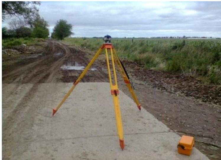
**Figura 53:** Instrumental utilizado para la nivelación
