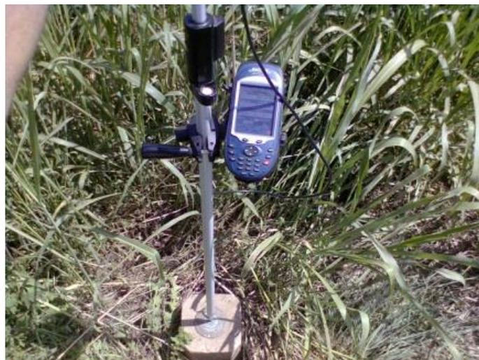
**Figura 44:** Georreferenciación de los registros con los Puntos Fijos existentes en la zona
