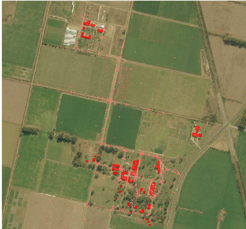
Figura IV.13: Nube de puntos de relevamiento sobre imagen satelital del predio. Fuente: elaboración propia, 2019.
