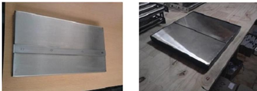
Las trampas magnéticas en nuestro proyecto se ubican sobre el conducto de ingreso del molino quebrador, según se puede apreciar en la siguiente imagen:
