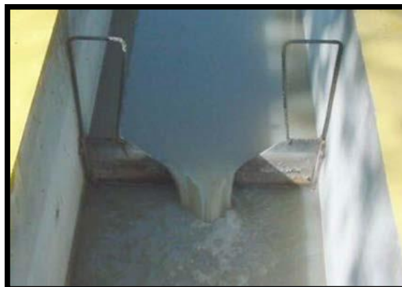
Figura 8.3. Aforador triangular. Fuente: Stewart Oakley, 2005.
