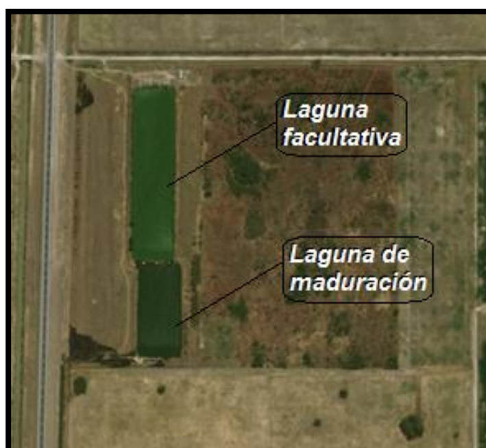
Figura 8.1. Planta de tratamiento existente.
