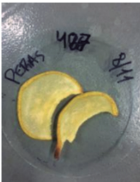
Fig. 15. Peras secadas de modo combinado (microondas 600 W) durante 4 min de un lado, reposo de 5,5 min, 4 min del otro lado, reposo de 5,5 min y 4 min nuevamente del primer lado, pretratadas por deshidratación osmótica/impregnación con lactato de calcio durante
