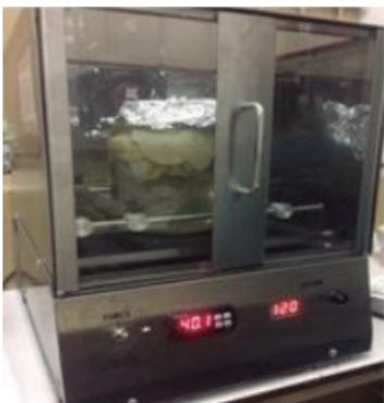
Fig. 4. Equipo de deshidratación osmótica: agitador orbital y sistema solución-pera en su interior
