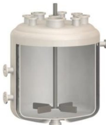
Figura 5.7-4: Reactor tanque agitado encamisado.
