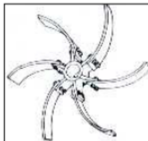
Figura 5.7-9: Agitador de tipo turbina hojas curvas
