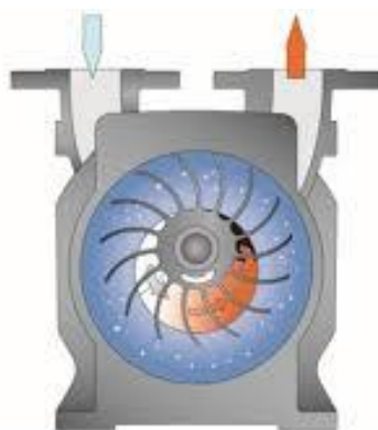
Figura 5.9-4: Bomba de vacío de anillo líquido.
