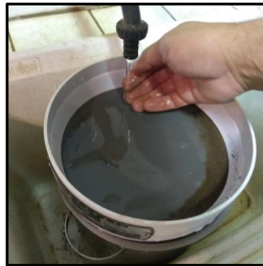
Figura 3.4: Lavado por tamiz 0,075 mm (N°200).
