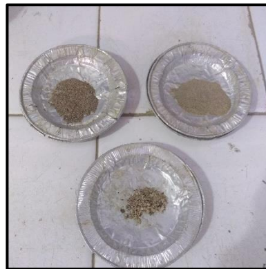
Figura 3.6: Pasante Tamiz 2 mm (N°10), Tamiz 4,25 mm (N°40) y Tamiz 0,15 mm (N°100).
