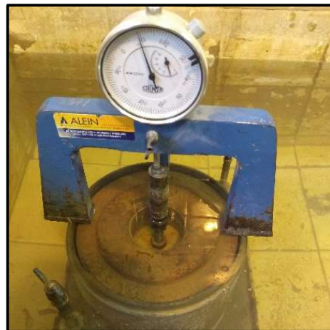
Figura 3.36: Colocación en agua y registro primera lectura.
