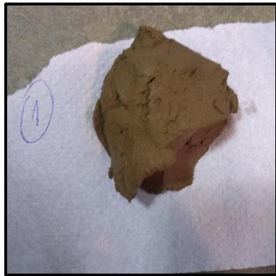
Figura 3.14: Mezcla de suelo tomado del LL.
