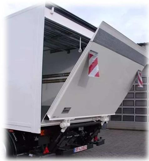
**Figura N° 7.1:** Foto ilustrativa de la plataforma con sus cintas reflectarias.
