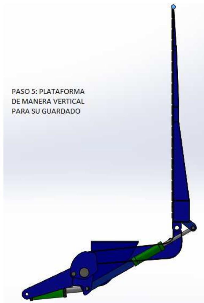
**Figura 2.19-E:** Plataforma en forma vertical.
