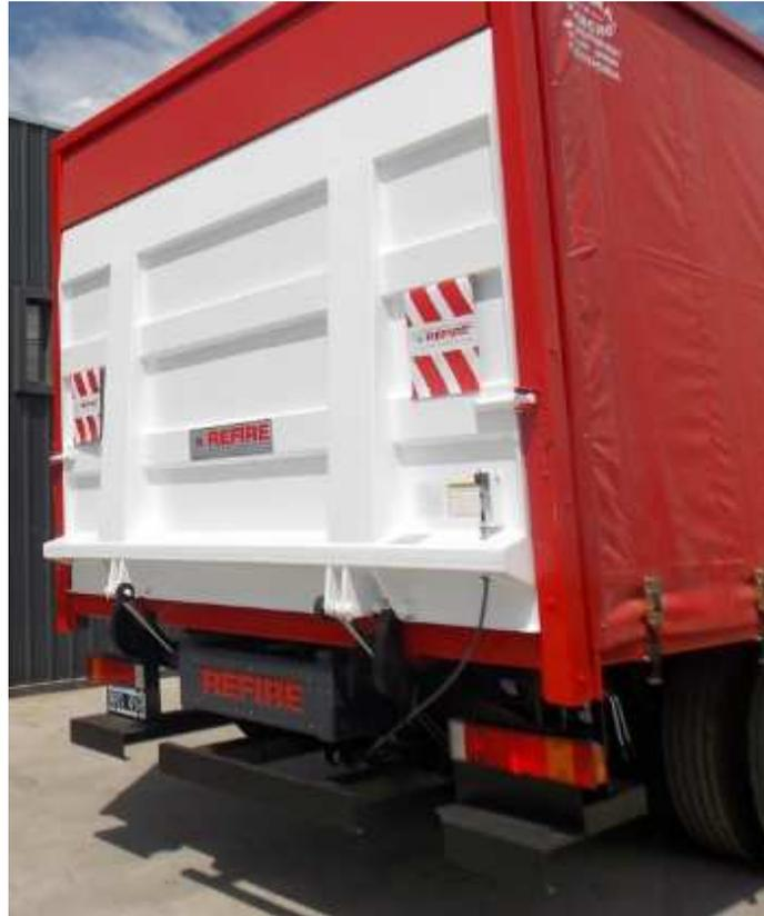
**Figura N<sup>a</sup> 7.2:** Paragolpes, soporte de luces y de patente incorporado.
