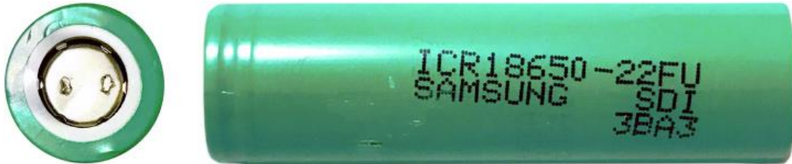
Figura 38: Celda de litio formato 18650
